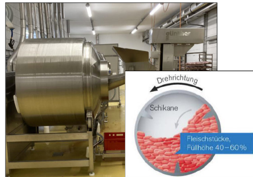
Kraftübertragung durch rotierende Trommel mit Schikanen
